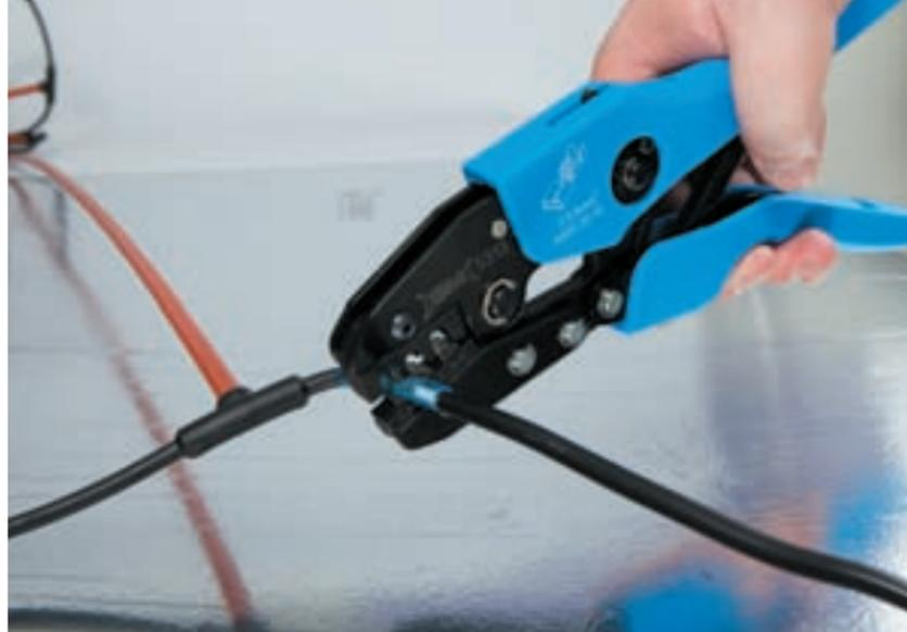
Рис. 11. Обжатие клещами соединительной гильзы
