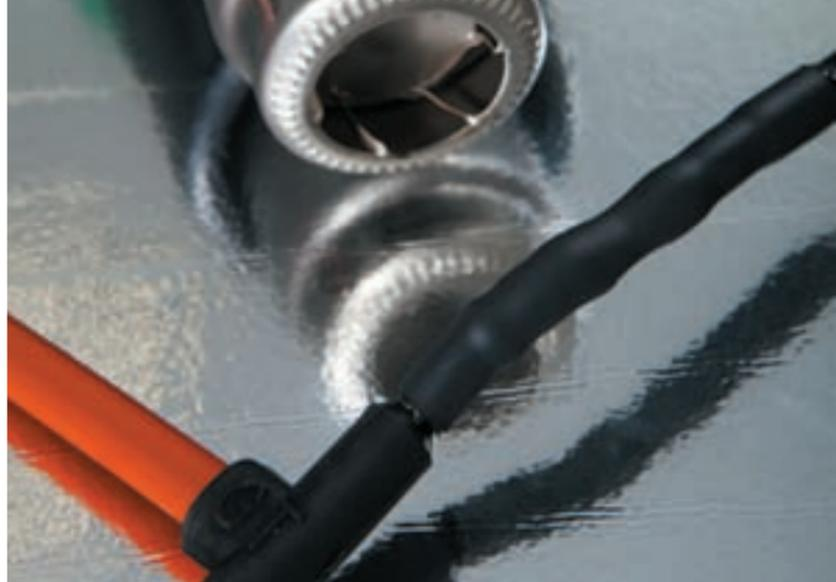
Рис. 13. Усадка термоусаживаемой трубки техническим феном
