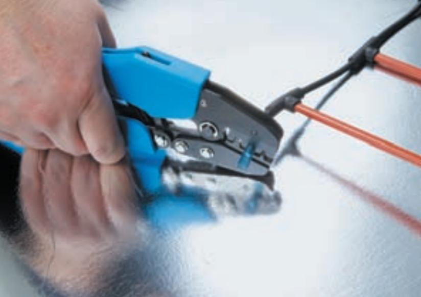
Рис. 6. Зажатие гильзы в термоусаживаемой трубке
