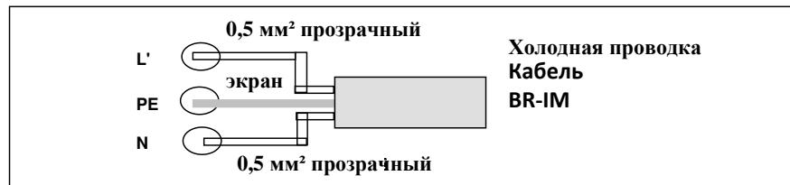
Подключение нескольких нагревательных матов производится параллельно! Максимально допустимый ток регулирующего устройства должен быть соблюден!
