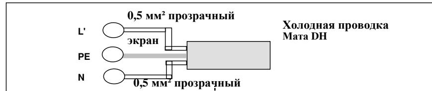
Подключение нескольких нагревательных мат производится параллельно! Максимально допустимый ток регулирующего устройства должен быть соблюден!
